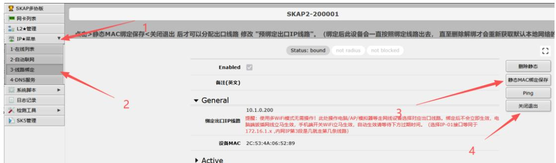
再次点击进去刚刚绑定的设备，在绑定出口 IP 线路选中对应的 L2 出口即可完成后台绑定的方法。优点：后台绑定无需记繁琐的网段，软路由会自动分配
