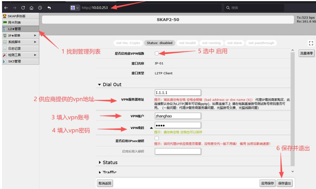
《推荐方法 1：手机与电脑设备端 通用手动设置静态指定内网 IP 走不同的 L2 出口》
